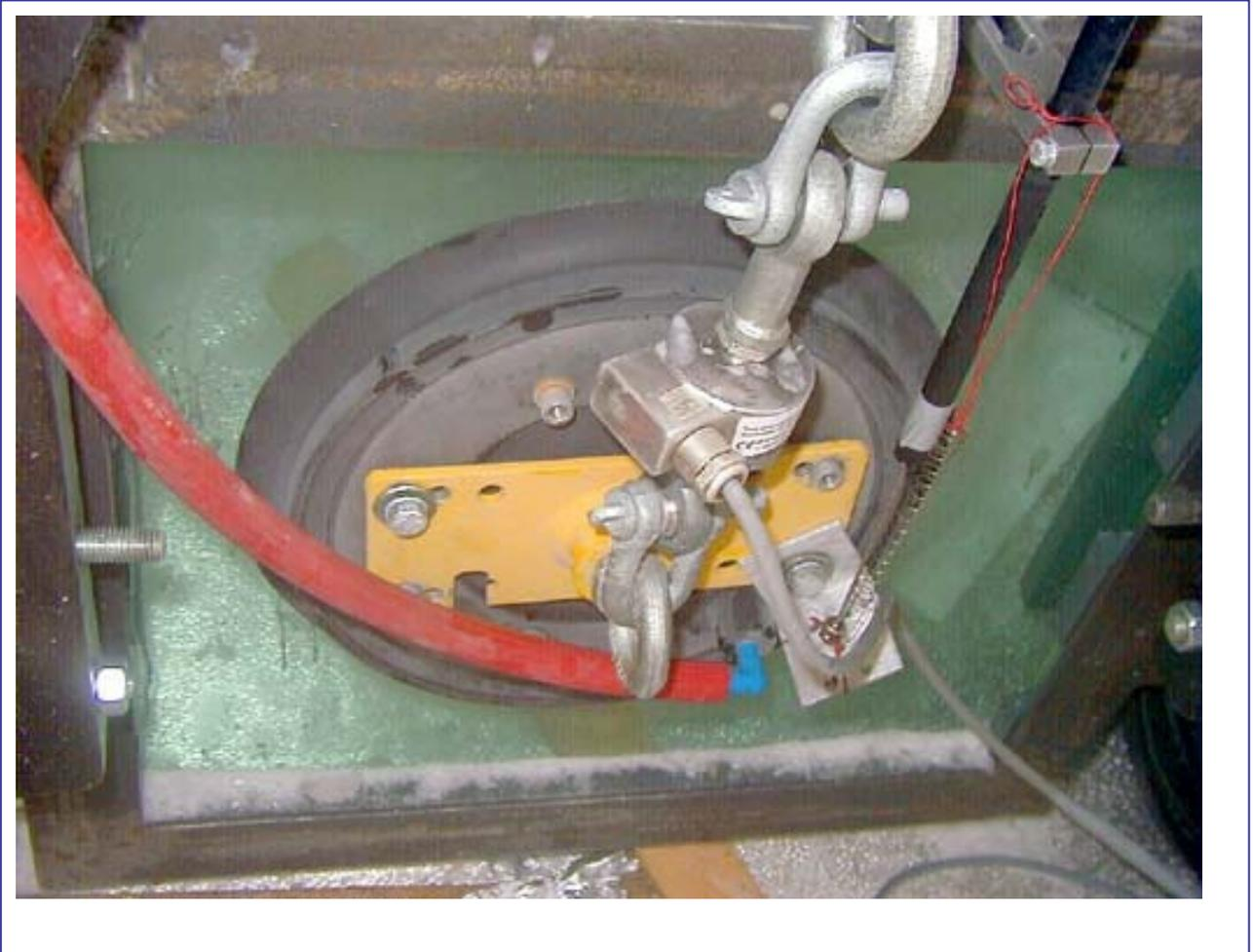
Bild 3: Sauger 388 bei  $-32,1\text{ }^{\circ}\text{C}$ , der Sauger zieht trotz kräftigem Anpreßdruck nicht an
